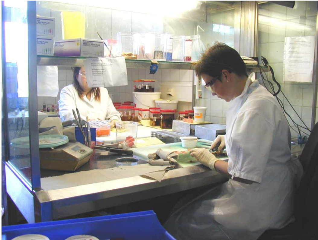
Bild 3: Pathologen-Arbeitsplatz mit integrierter zentraler mittiger Ablufführung, die Assistentin sitzt gegenüber, reicht Proben an und führt Schreibarbeiten aus.
