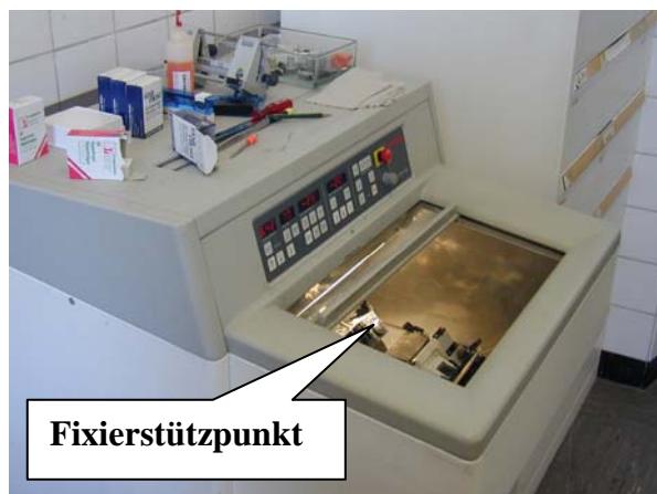
Bild 4: Schnellschnitt-Mikrotom mit geöffnetem Arbeitsraumschieber.
